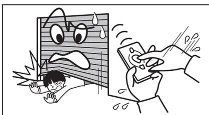
シャッターを閉めているときに開けたい場合は一旦「STOP」スイッチを押してから、開ける操作をしてください。「STOP」スイッチを押さないとシャッターは閉まりつづけます。
